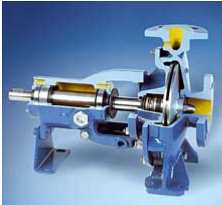
Figura 2.1. Pompa monostadio (Robuschi)
